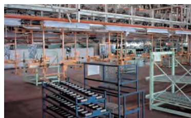
Door sub-assembly line
